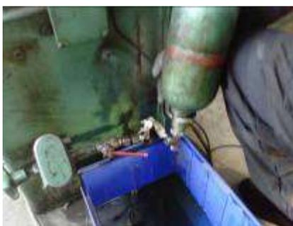
3. Isoler le circuit puis déposer l'accumulateur
