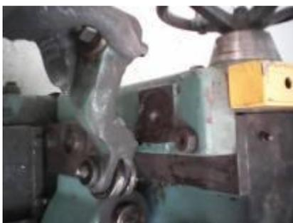
**d. A l'aide d'une clé de 19 poser le serre tôle contre la table**
