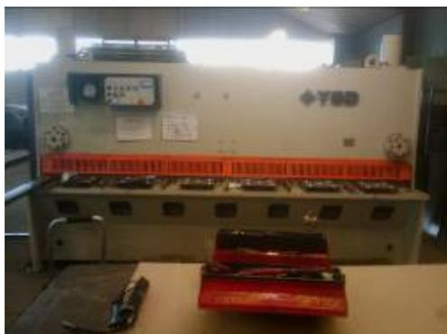
**Objectif :** - Dépose des lames, retournement, réglage jeu + changement câble ombre de coupe et réglage tension chaîne de butée arrière
