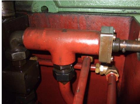
Au repos l'huile retourne à la bêche par les 2 tuyaux sur le côté droit du distributeur
