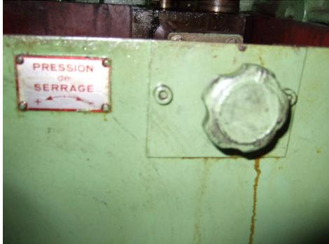
Aux endroits où les feuilles bougent desserrer légèrement les vis de serrage et reprendre aux contres-vis afin de déformer la règle et reprendre le jeu.
