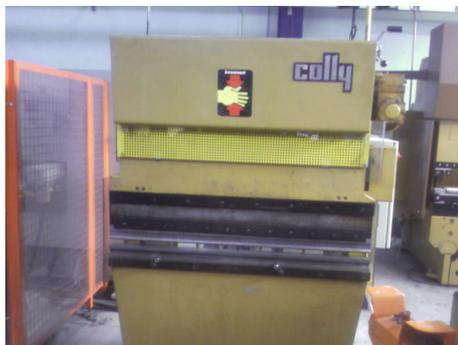
1. Placer 2 plaques de tôles de même épaisseur de chaque côté et à distance égale des vés et plier à la volée.
