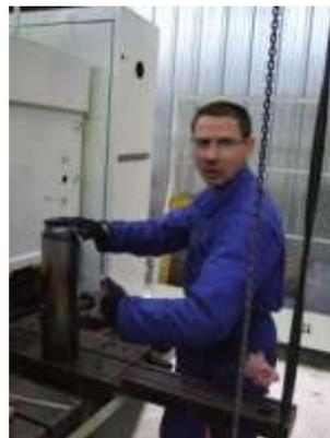
4. Retourner le fût et réinsérer la tige à l'aide d'un gros aimant (force au moins 30 kg) et revisser selon mode opératoire changement joints de vérin différentiel
